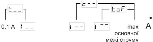
Рисунок 1. Взаємозв'язок меж струму з часом відключення за такими межами
