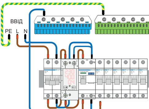
Схема 2. Варіант монтажної схеми ZUBR MF2
