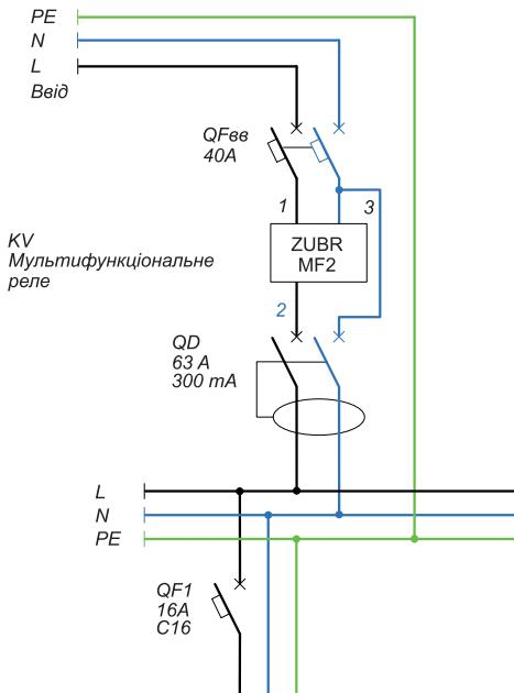
Схема 1. Варіант електричної схеми ZUBR MF2
